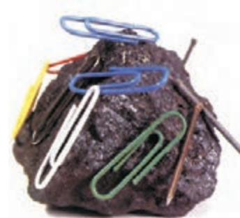
شکل ۱-۳ سنگ آهنربای طبیعی. تالس که اغلب از او به عنوان پدر علم یونان یاد می‌شود، ماده کانی مگنتیت \text{Fe}_3\text{O}_4 را که ویژگی آهنربایی دارد می‌شناخت.
