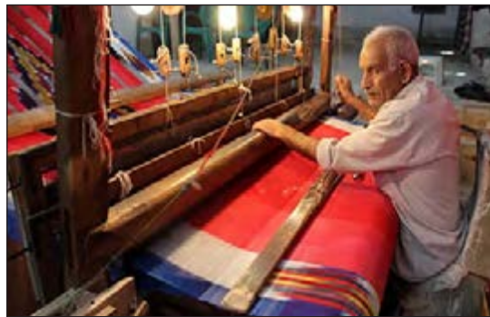
دستگاه ساده بافی (دارایی بافی)
