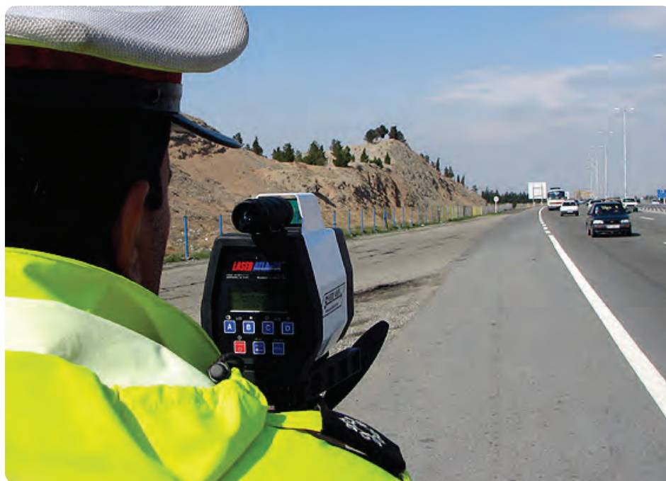
شکل ۳-۳۰ تعیین تندی خودروها به کمک اثر دوپلر
