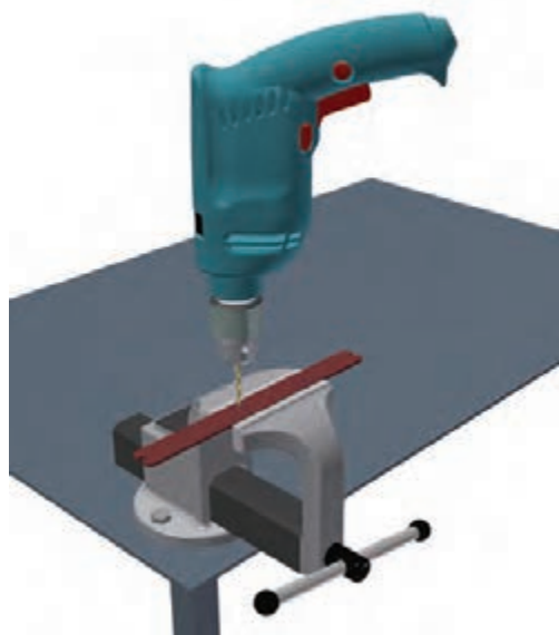
شکل ۵-۲۳. سوراخ کاری با دریل
