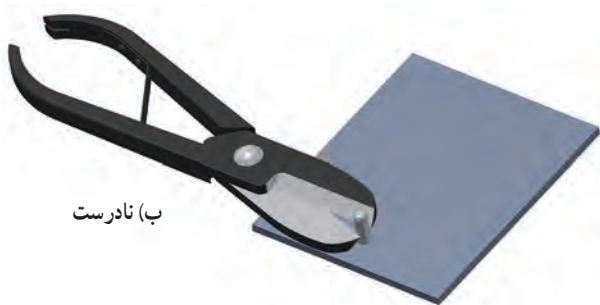
شکل ۵-۸. روش استفاده از قیچی
