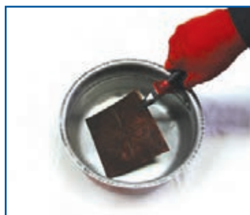
شکل ۹-۱۱- سرد کردن پلاک مسی با آب
