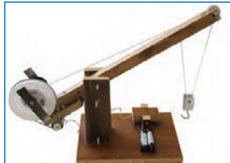
الف) ساز و کار حرکتی جرثقیل اسباب بازی
