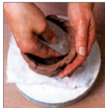
▲ پرداخت کردن سطح داخلی ظرف سفالی.
