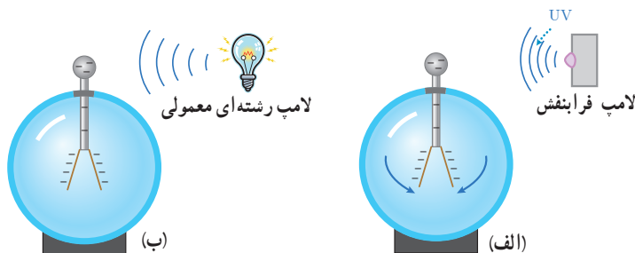
شکل ۱-۴ الف) برهم‌کنش نور فرودی فرابنفش با کلاهک برق‌نما سبب می‌شود تا ورقه‌های آن به سرعت به هم نزدیک شوند. ب) در حالی که برهم‌کنش نور مرئی گسیل‌شده از یک لامپ رشته‌ای تغییری در انحراف ورقه‌های برق‌نما به وجود نمی‌آورد.
