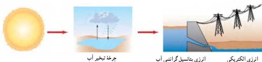
شکل ۱۲. انرژی پتانسیل گرانشی آب پشت سد توسط توربین‌ها و مولدها به انرژی الکتریکی تبدیل می‌شود.
