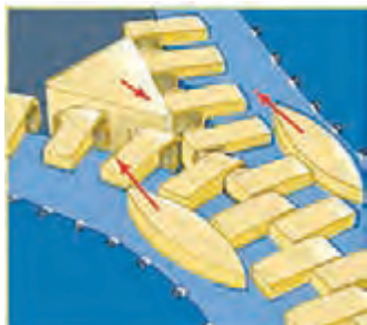
زیب نمونه‌ای از فناوری قرن بیستم است که از سه گوه بهره می‌برد. دسته زیب از گوه‌هایی تشکیل شده که تلاش کوچک ما را به نیروی بزرگی تبدیل می‌کنند که زیب را باز می‌کند و می‌بندد. بدون کمک این گوه‌ها، متصل کردن یا جدا کردن دندانهای زیب تقریباً امکان پذیر نیست.
