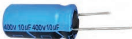
شکل ۴۶-۱ تصویری از یک خازن که روی آن ظرفیت و اختلاف پتانسیل بیشینه قابل تحمل نوشته شده است.
