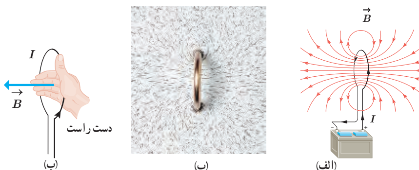
شکل ۳-۱۷ الف) خط‌های میدان مغناطیسی در اطراف یک حلقه حامل جریان. ب) طرح خط‌های میدان مغناطیسی یک حلقه حامل جریان با استفاده از براده آهن. پ) استفاده از قاعده دست راست برای تعیین جهت \vec{B} یک حلقه حامل جریان.
