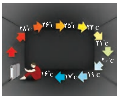
شکل ۴-۲۸ گرم شدن هوای اتاق به روش همرفت
