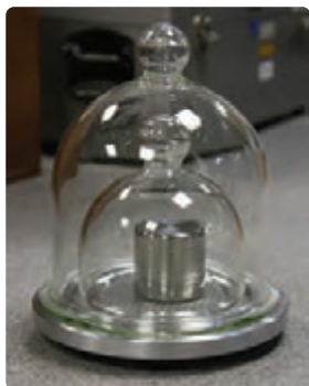
شکل ۱-۷ استاندارد ملی کیلوگرم که نسخه دقیق‌تری از استاندارد بین‌المللی سور فرانسه است. این نمونه، در مرکز اندازه‌شناسی در سازمان ملی استاندارد ایران نگهداری می‌شود.
