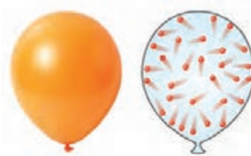
شکل ۲-۶ حرکت نامنظم ذرات گاز درون یک بادکنک
